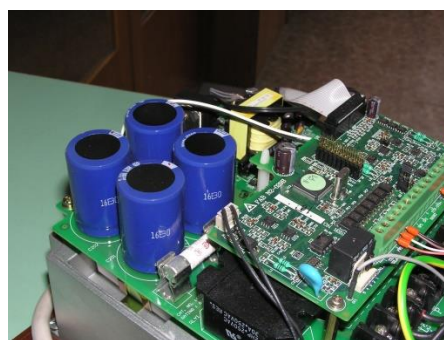
Obr. 25 Příklady provedení frekvenčních měničů pro průmyslové pohony s asynchronními motory, pohled na řídicí obvody frekvenčního měniče – jsou patrné i elektrolytické kondenzátory stejnosměrného meziobvodu
