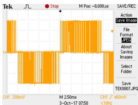
24 Oscilogramy napětí a proudu na výstupu střídače při napájení asynchronního motoru
